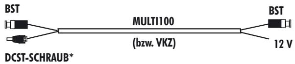
\*DCST-SCHRAUB (DC-Stecker mit Schraubklemmen) ist im Lieferumfang der Kamera enthalten
