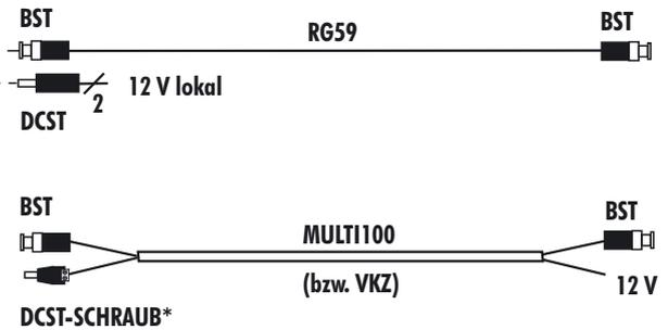
\*DCST-SCHRAUB (DC-Stecker mit Schraubklemmen) ist im Lieferumfang der Kamera enthalten
