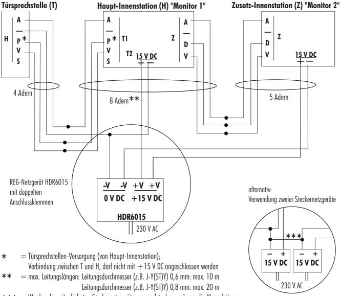
\*\*\* = Werden die mitgelieferten Steckernetzgeräte verwendet, dann müssen die Masseleitungen miteinander verbunden werden, ansonsten wird ein Brummton erzeugt.
